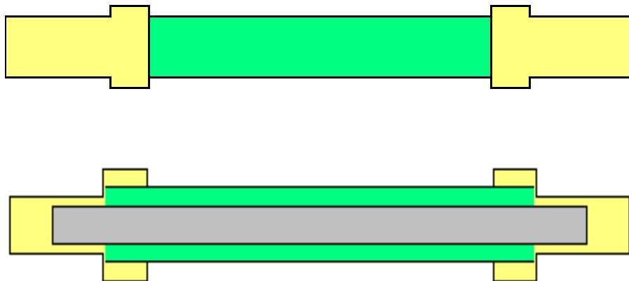
Bild 5.9: Der Querschnitt einer fertig gestellten Einfachbindung
