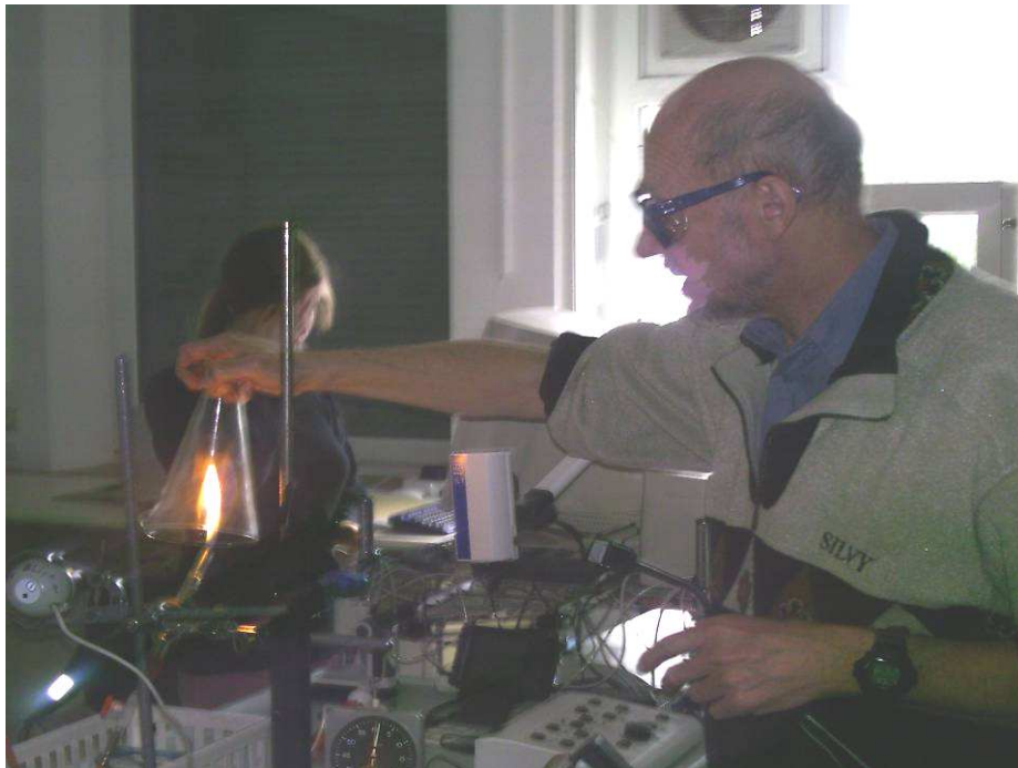
Bild 21.8: Nachweis von Wasserstoff im Methan
