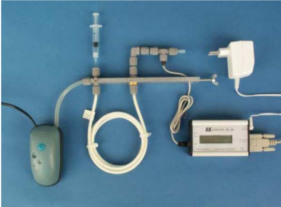
Bild 21.25: Aufbau des Low-Cost-Gas-Chromatographen AK LCGC-03
