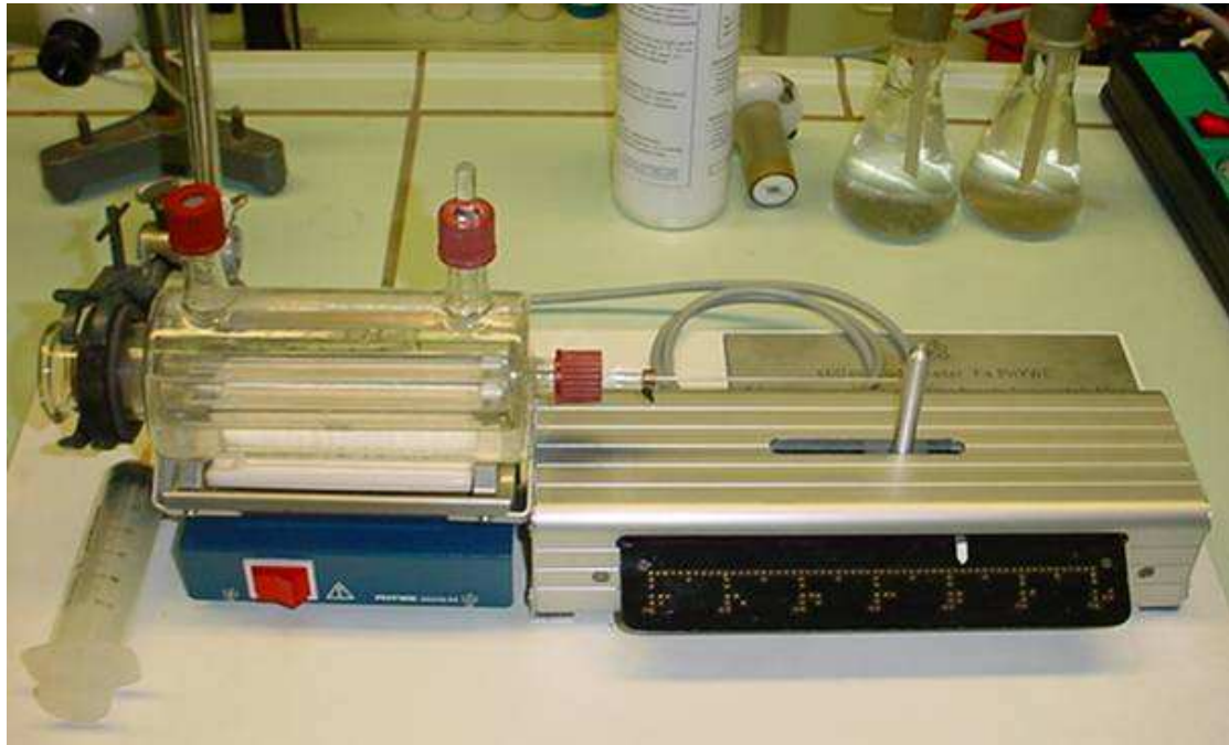
Bild 21.22: Das „Stille Eudiometer“ mit angebrachter Braille -Skala
