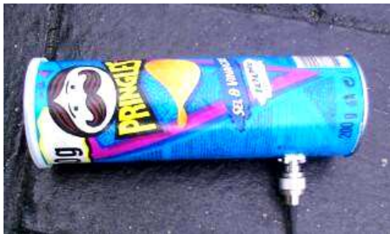
Bild 21.10: Eine selbstgebaute Explosionskammer
