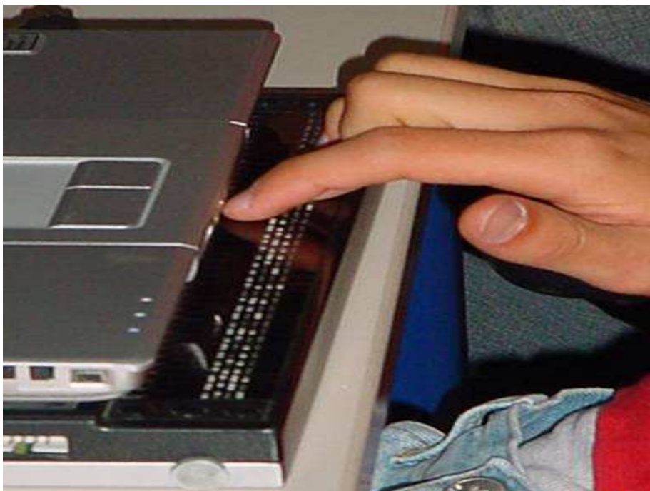
Bild 1.11: Vergrößerung einer 8-Punkt- Braille-Zeile für den Laptop
